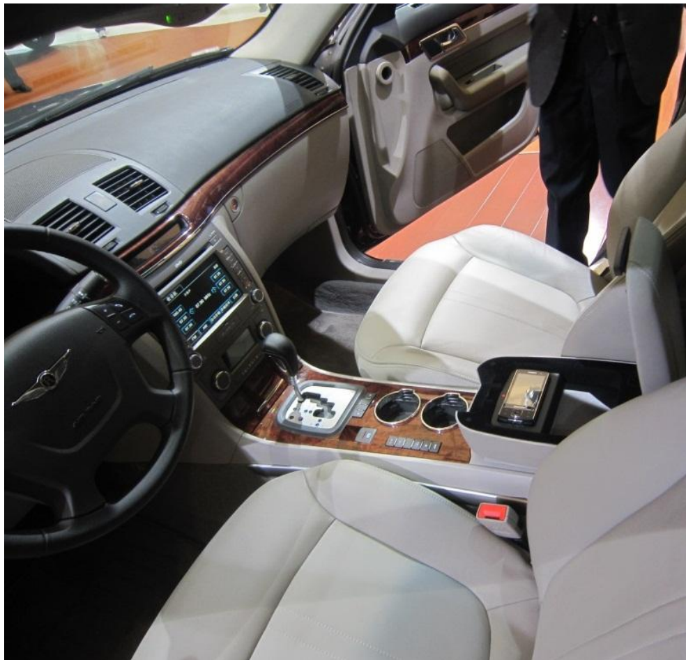
図 2:上海モーターショーに展示された Chery(奇瑞)の Riich G6 では、中央アームレストに無接点充電技術が装備されています。
